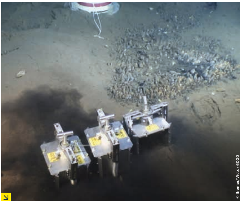
Prélèvement et mesure in situ sur un habitat à bivalves à l'aide du ROV Victor 6000
