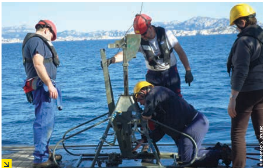
Échantillonnage de sédiment au moyen du carottier Reineck pour l'analyse des contaminants
