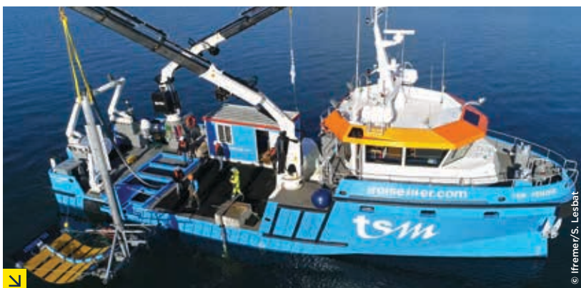
Tests du prototype de la membrane ondulante à l'échelle 1/6 e en rade de Brest
